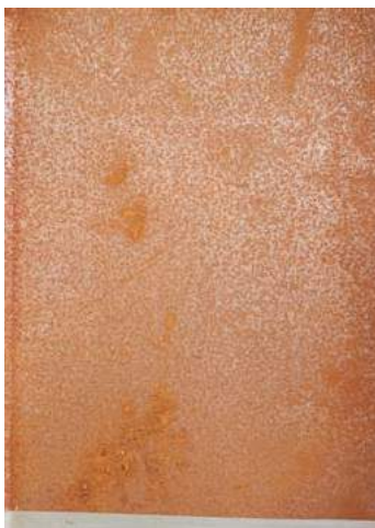
Σκουριά σε κάθετη μεταλλική επιφάνεια.
