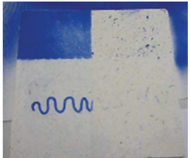
Αποτέλεσμα Anti-graffiti σε πορώδη επιφάνεια. Η δεξιά πλευρά εφαρμοσμένη με SurfaPore AG καθώς έχει υποβληθεί σε καθαρισμό με ζεστό νερό χωρίς τρίψιμο.
