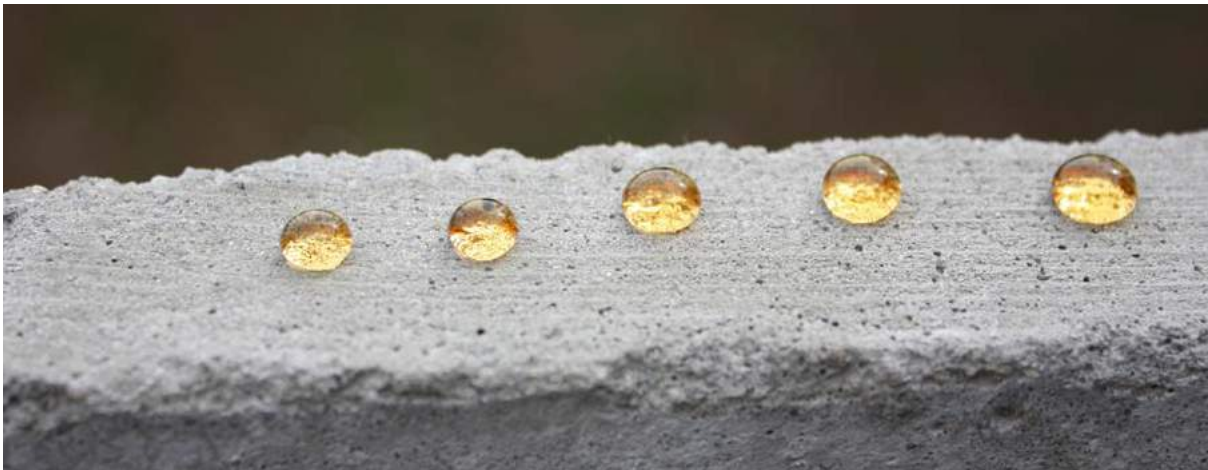
Σταγόνες λαδιού σε προστατευμένη τσιμεντοειδή επιφάνεια με SurfaPore M.
