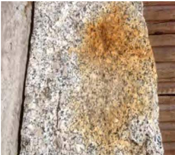
Υπολείμματα σκουριάς σε κομμάτι γρανίτη.
