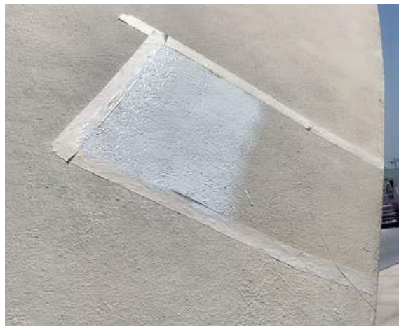
Εφαρμογή του SurfaPaint SCP Concrete Acrylic Enamel Paint. Το δείγμα είναι εκτεθειμένο για 6 μήνες στις καιρικές συνθήκες. Προσέξτε τις διαφορές στην λευκότητα της επεξεργασμένης επιφάνειας και της αρχικής επιφάνειας.
