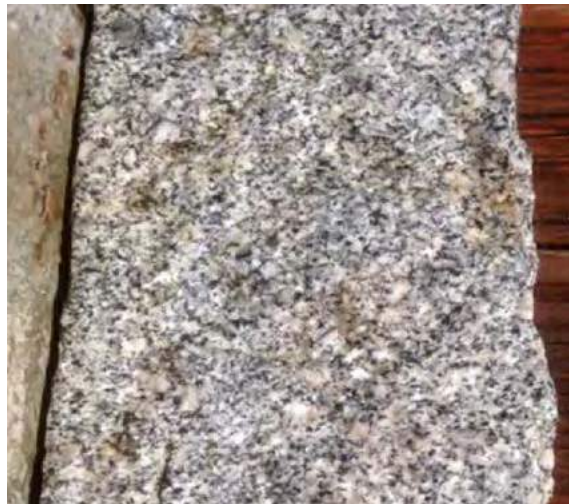
Μετά την εφαρμογή του DeSalin Gel Rust Remover. Η σκουριά έχει απομακρυνθεί πλήρως.
