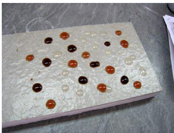
Βαφή (αριστερά) και καθαρισμός με κρύο νερό (δεξιά) ενός πλακιδίου από φυσικό λίθο επεξεργασμένο με SurfaPaint Stone Varnish WB.
