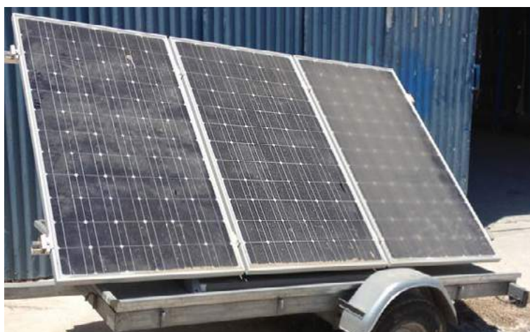
Δύο πάνελ αριστερά έχουν υποστεί κατεργασία με SurfaShield G, ενώ το αρχικό (δεξιά) παραμένει χωρίς θεραπεία για έξι μήνες (Κύπρος). Παρατηρήστε την συσσώρευση σκόνης στο μη επεξεργασμένο πάνελ.
