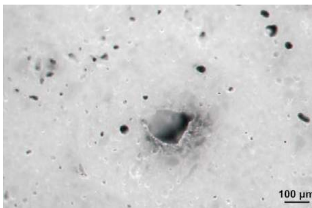
Μικροσκοπική εικόνα μαρμάρινης επιφάνειας, που υποβλήθηκε σε γυάλισμα. Η επιφάνεια και οι οπές συσσώρευσης βρωμιάς είναι ορατές.
