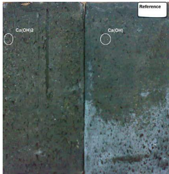
Μαύρα κεραμικά τούβλα μετά από δοκιμή αλατονέφωσης: αριστερά με το σύστημα NanoPhos και δεξιά χωρίς επεξεργασία.
