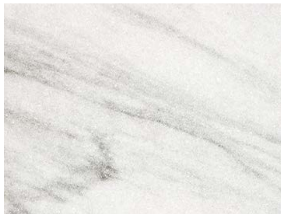
Αφαίρεση των λεκέδων από κόκκινο κρασί στο μάρμαρο Θάσου μετά την εφαρμογή του DeSalin T.
