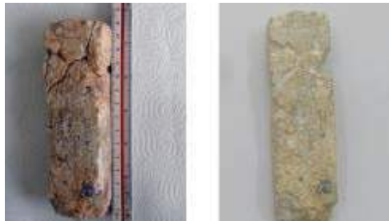
Αιγυπτιακό δείγμα ψαμμίτη από ασβεστίτη πριν (αριστερά) και μετά από εφαρμογή με SurfaPore FX WB (δεξιά).
