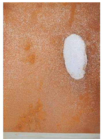
Τελικό αποτέλεσμα μετά από δέκα λεπτά εφαρμογής του DeSalin Rust Remover.
