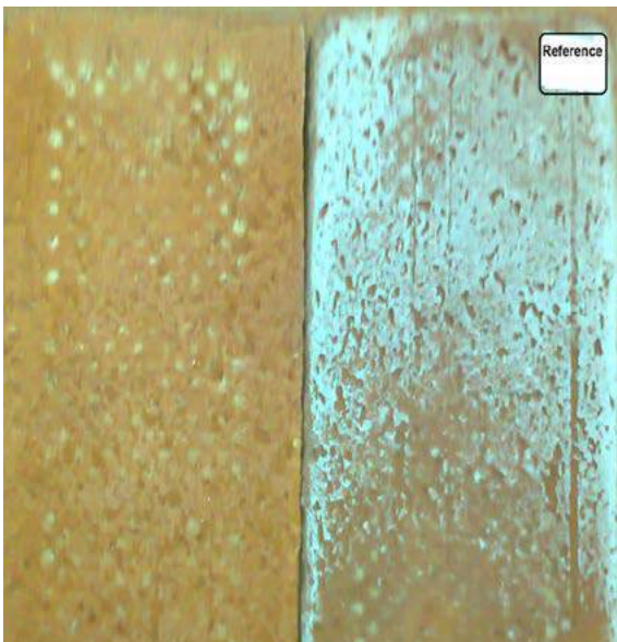
Κόκκινα κεραμικά τούβλα μετά από δοκιμή αλατονέφωσης: αριστερά με το σύστημα NanoPhos και δεξιά χωρίς επεξεργασία.
